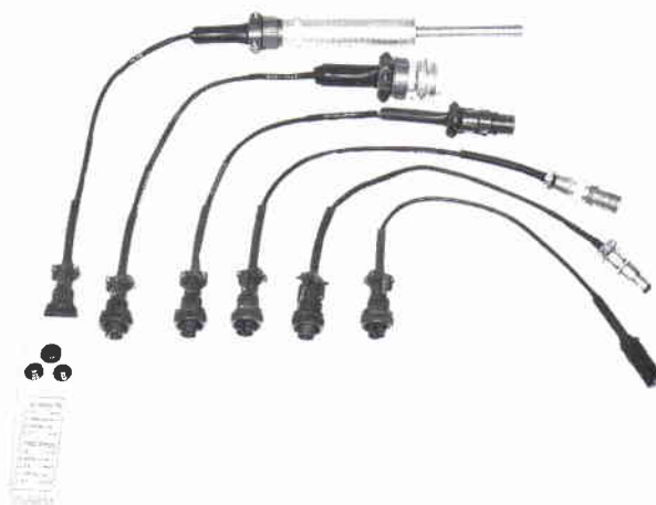
Kretsprovaren med anslutningar.
